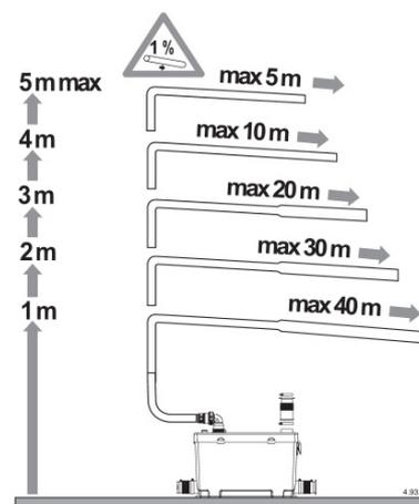
L'arrivée de la douche ou de la baignoire doit être au min. 18cm au-dessus du niveau plancher du GEOCLEAN.
